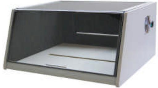
Die Schallschutzhaube unserer neuen HH-CM Serie sorgt für einen ruhigeren Betrieb Ihrer Nadeldrucker, Matrixdrucker. Sie verfügt über einen sehr stabilen Aluminiumprofil-Rahmen für die Acrylglascheibe, Gaslifffedern mit einstellbarer Winkel- und Krafteinstellung, einer frei konfigurierbaren Rückwand aus 4 einzelnen Segmenten, einem frei konfigurierbaren Boden aus 3 einzelnen Segmenten sowie einem ruhigen Durchsatzstarken ausblasenden Lüfter.
